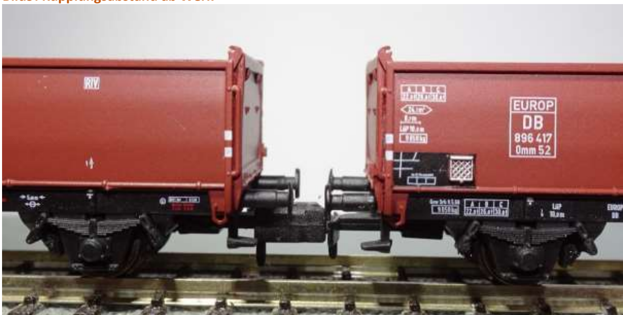
Bild10: Kupplungsabstand kurz/ Lieferzustand
