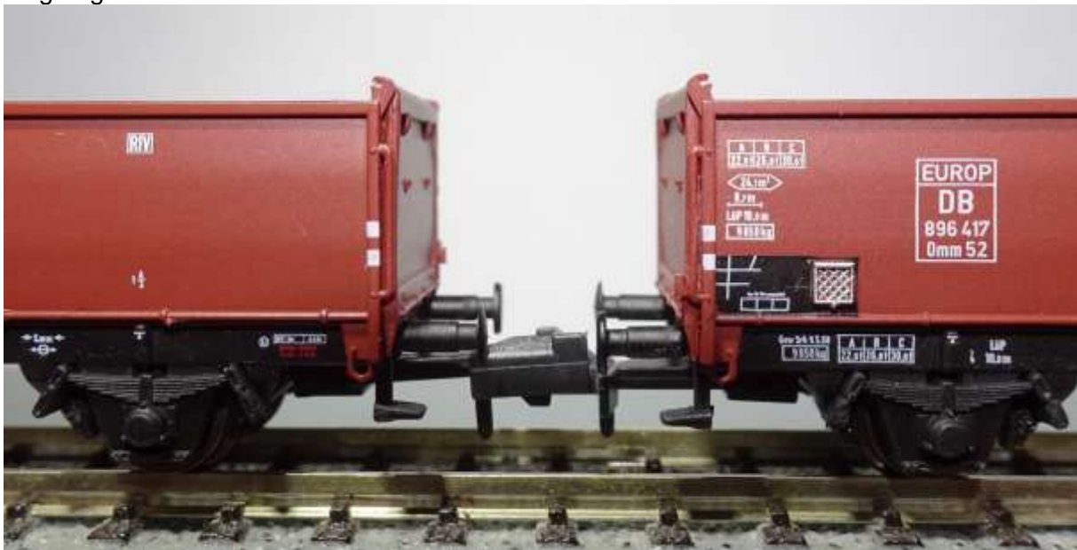
Bild9: Kupplungsabstand ab Werk
