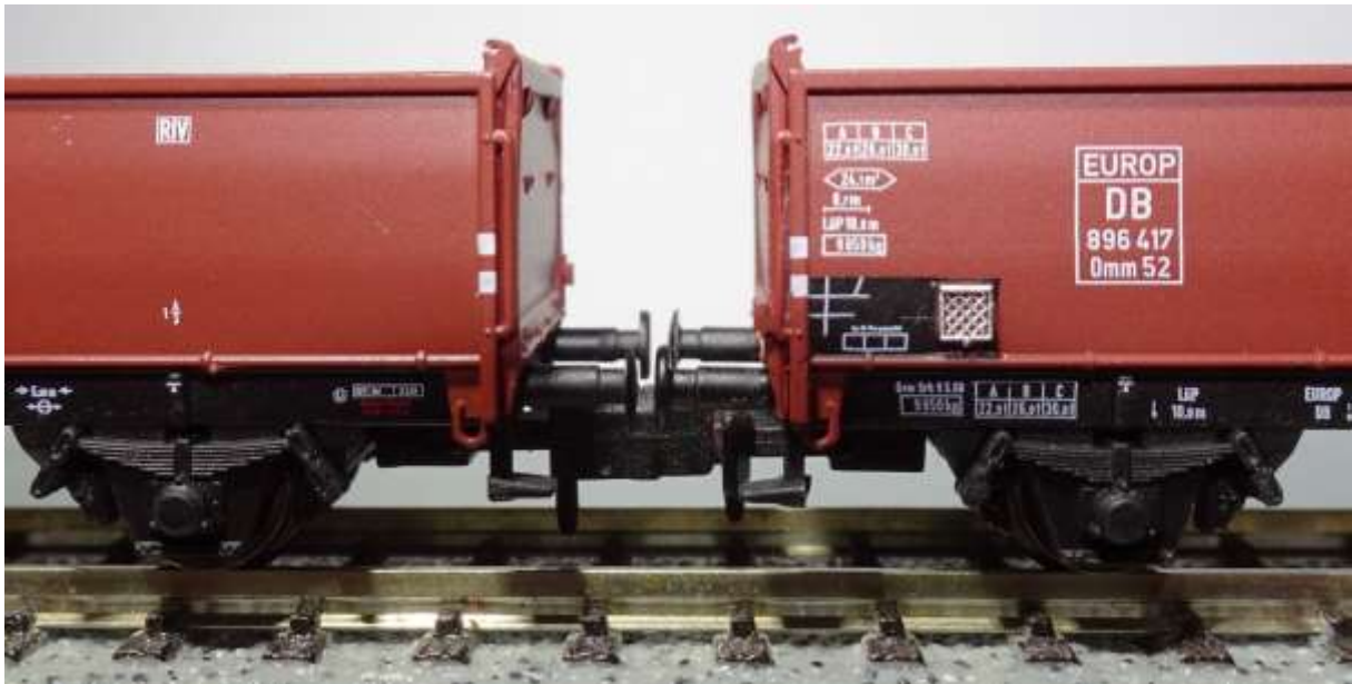
Bild11: Kupplungsabstand mit beigefügter Kurzkupplung
