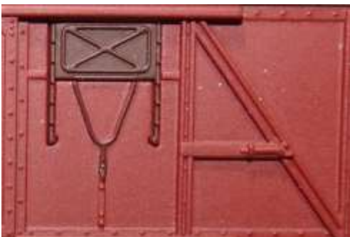
Bild 14 Lüfter und Stopper Gos 253 (neu)
