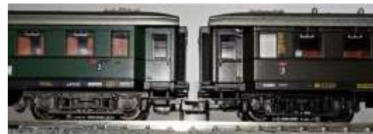
Bild 13: Höhenvergleich Flm alt/neu mit 5,6mm Rädern
