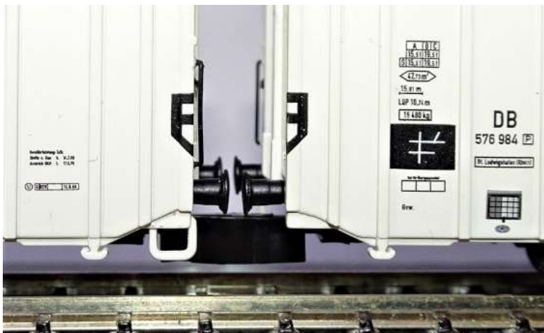
Foto 8: Kuppelabstand mit PEHO Clipskupplung
