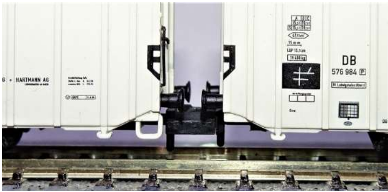
Foto 7: Kuppelabstand ab Werk
