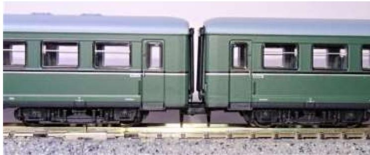
**Bild 9: Kuppelabstand ab Werk**
