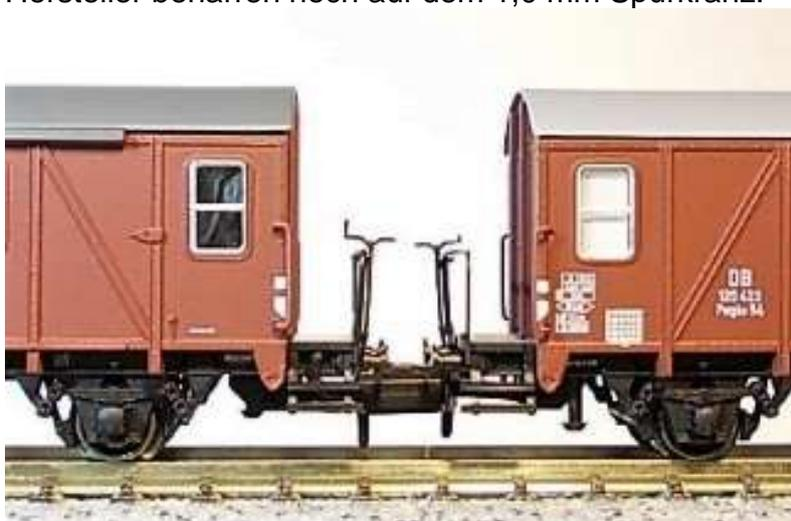
Foto 10: Kuppelabstand Pwghs 54 ab Werk
