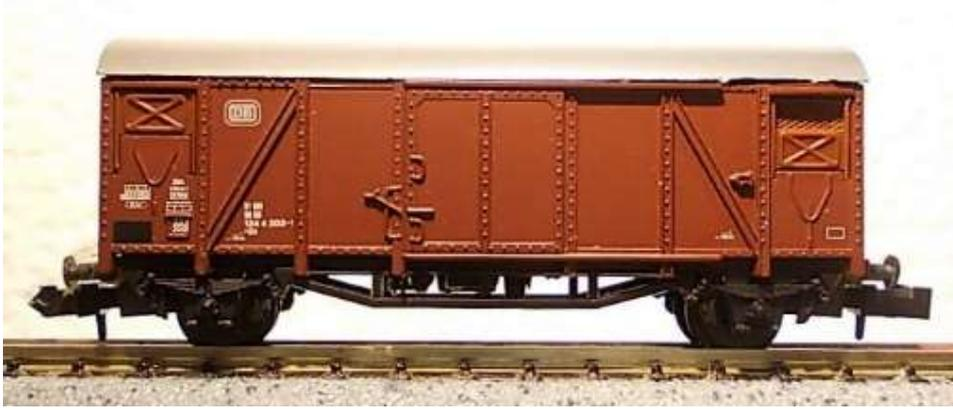
Eigenbau 2001 Gms 45 (Wagenkasten Roco, Fahrwerk Roco Rungenwagen gekürzt) – Epoche IV
