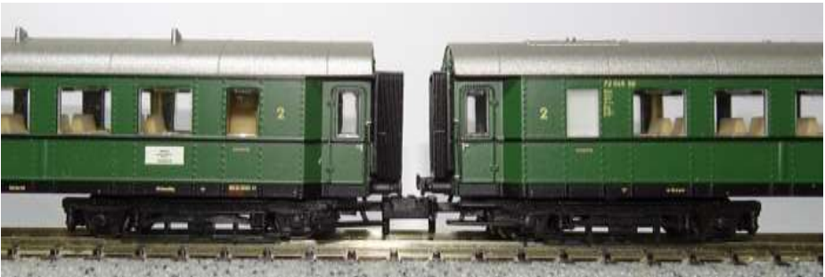
Liliput Kuppelabstand ab Werk; beide Wagen mit falschen Drehgestellen
