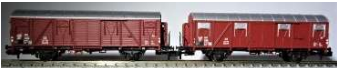
Bild 4 Wagen Ep 3 DB Bremserhaus Bretter- und Plattenwand
