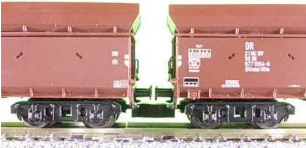
Bild 7 mit PEHO Clips—Kupplung kurzgekuppelt
