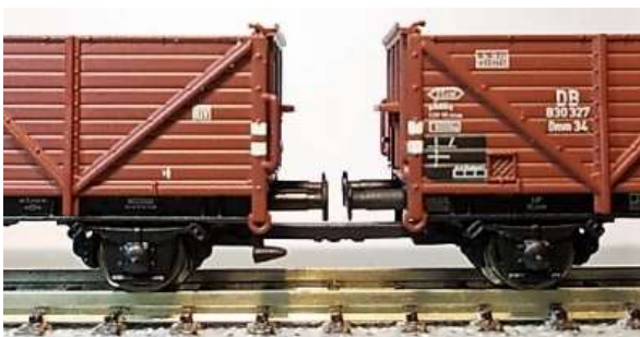
Bild12 Kupplungsabstand mit MU-Kupplungsstange 13,5 mm
