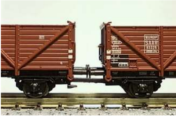
Bild13 Kupplungsabstand mit MU-Kupplungsstange 11,5 mm
