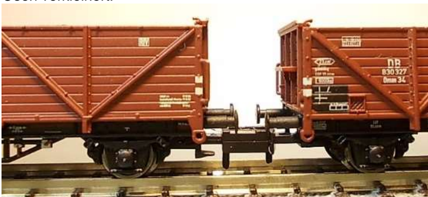
Bild16 Wagenecksäulen Omm 34 (links) und Omm 37 (rechts)
