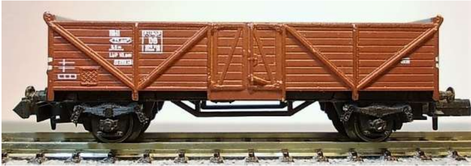
Bild3 Ommu Klagenfurt DB mit überflüssigem Sprengwerk
