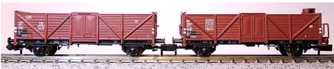
Bild11 Kupplungsabstand normal Omm 34
