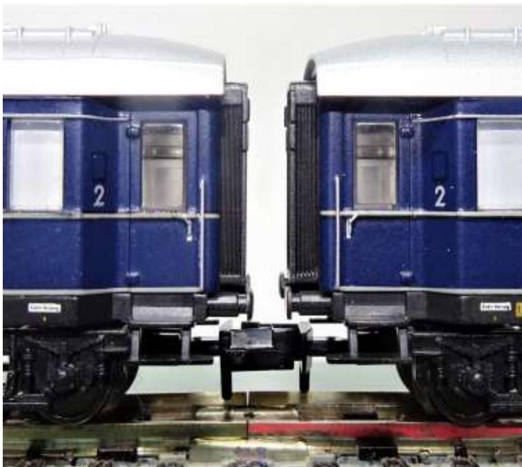
Bild 9: Höhenvergleich unterschiedliche Räder: (li 5,6 mm re 6,2 mm)
