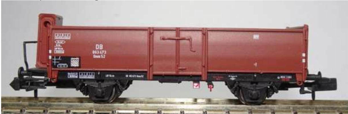
**Bild3: Omm 52 mit Bremserhaus**
