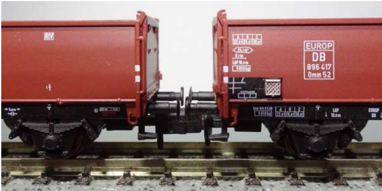
Bild11: Kupplungsabstand mit beigefügter Kurzkupplung
