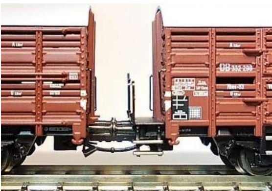
Bild14 Kuppelabstand MU Kuppelstange 13,5mm
