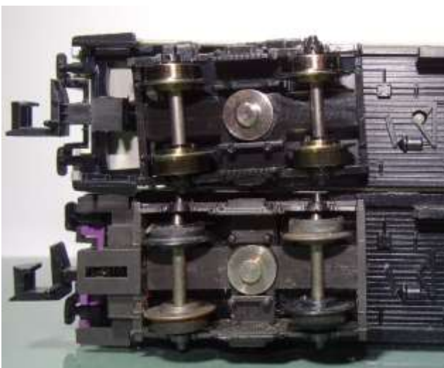
Foto 14: Fahrgestelle Minitrix Popwagen (2019 oben, 1973 unten)
