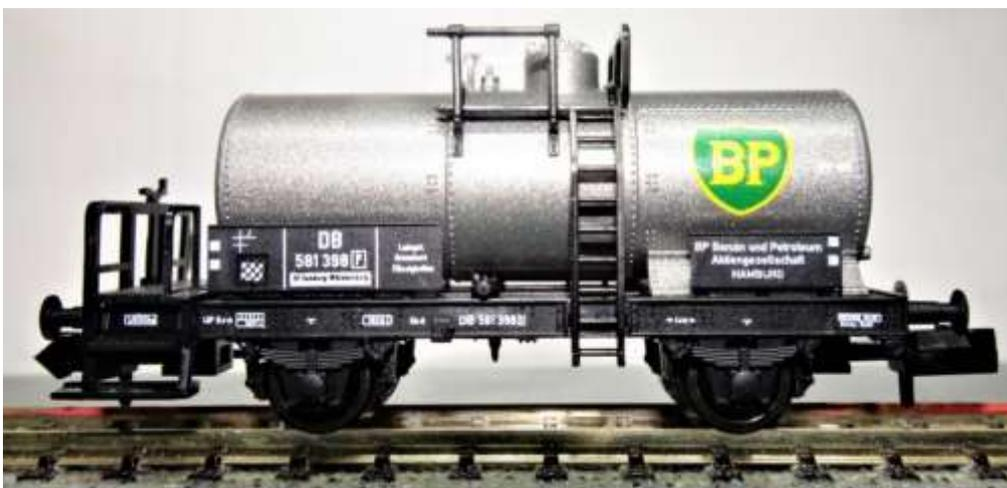
Bild 9: BP-Kesselwagen mit Bremserbühne DB
