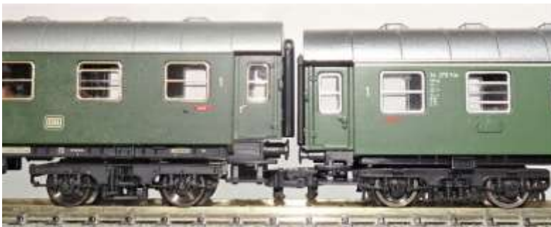
Bild 7: Höhenvergleich Umbauwagen Fleischmann (li) und Roco (re)
