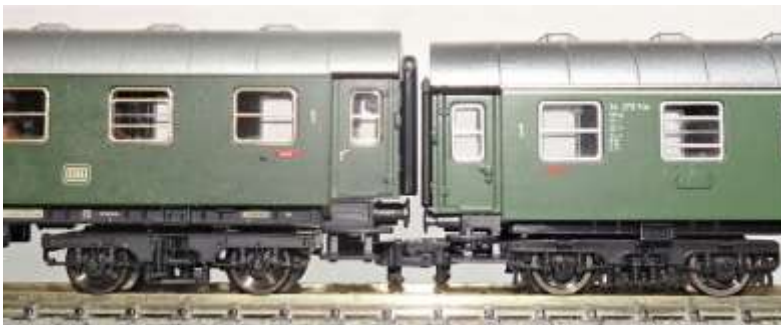
Bild 7: Höhenvergleich Umbauwagen Fleischmann (li) und Roco (re)
