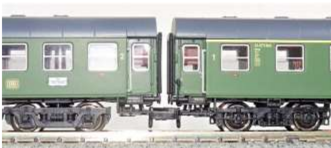
Bild 18: Kuppelabstand Umbauwagen ab Werk
