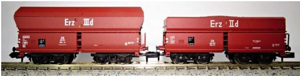
Bild 6 Minitrix Ootz 43 Erz III d (re) und Ootz 41 Erz II d
