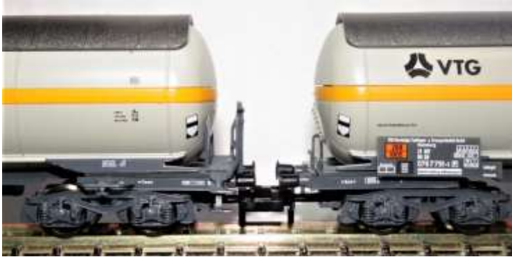
Bild 6: Kuppelabstand ab Werk
