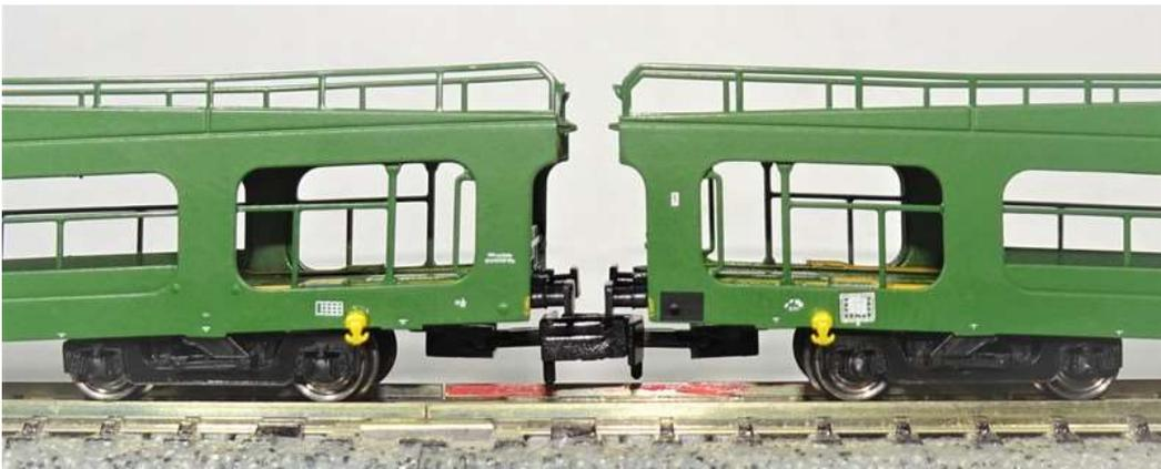
**Bild 8: Kuppelabstand ab Werk**
