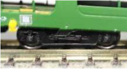
**Bild 9: Modell des Drehgestells Y 30**
