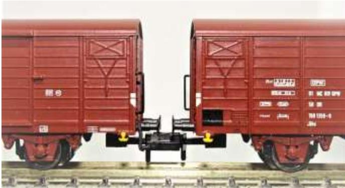
**Bild 11: Kuppelabstand ab Werk**
