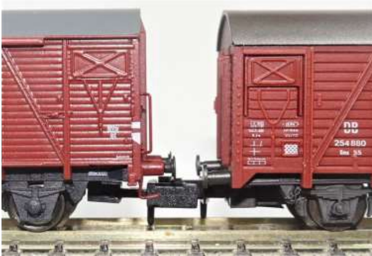
Bild 6: Pufferhöhe Arnold (li) und Roco (re)
