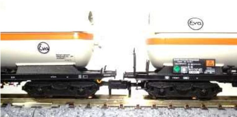
**Bild 7: Kuppelabstand ab Werk**
