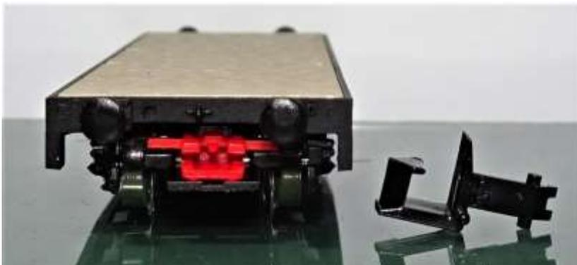
Bild 7 Kupplungsaufnahme des Fleischmann SSys
