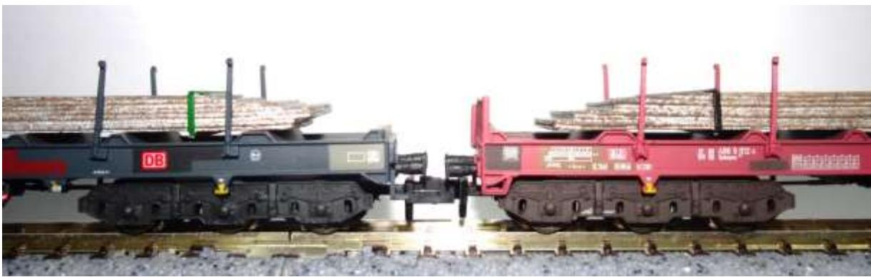
**Bild 8: Kuppelabstand ab Werk**
