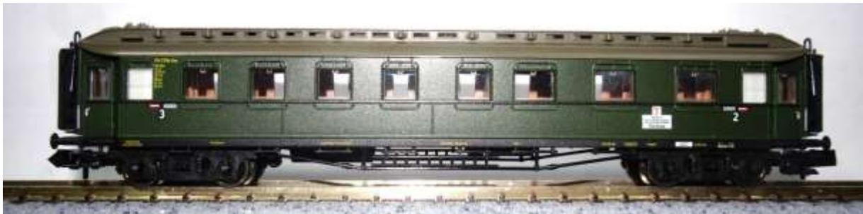
**Bild 6: BC4ü pr11 der frühen DB mit elektr. Beleuchtung**
