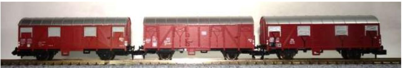
Bild 14: Minitrix G-Wagen 3 Generationen- Kuppelabstand mit Flm-Erbse (re)- li alt- Mitte (neu)
