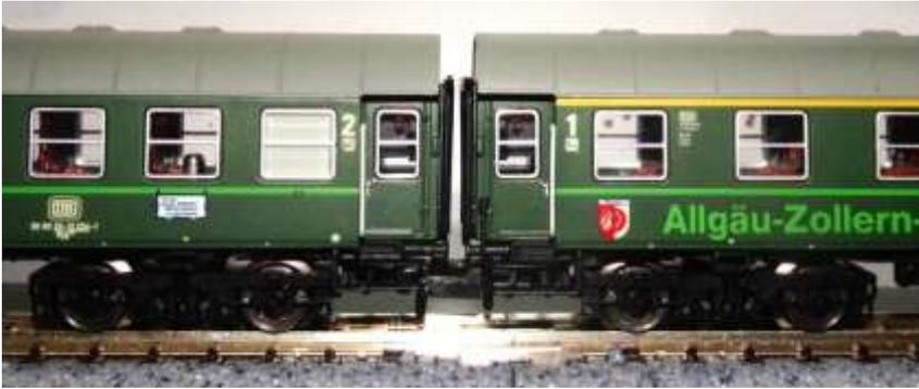
**Bild 7: Kuppelabstand ab Werk**
