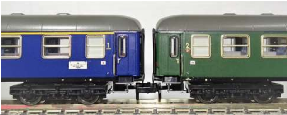
Foto 8: Kuppelabstand bei neuen Fleischmann-Wagen
