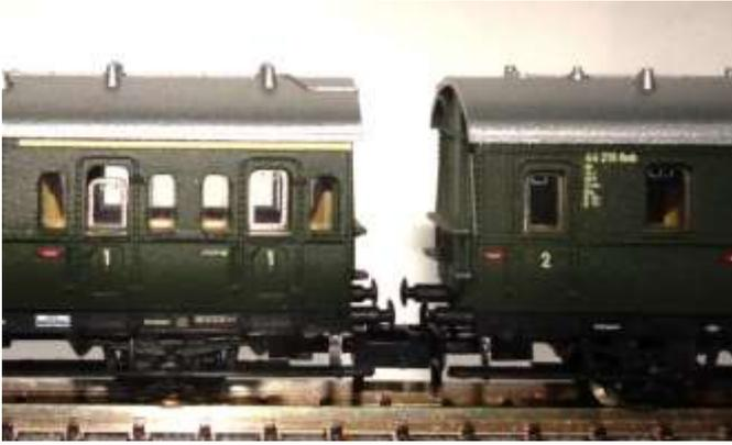
**Bild 16: Kuppelabstand der Abteilwagen**
