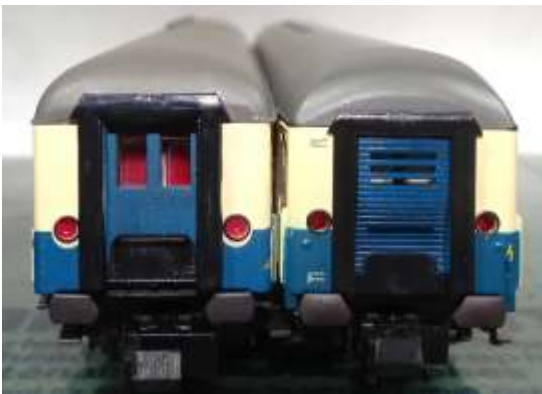
Bild 14: Übergangstüren Gepäckraum (re Flm)
