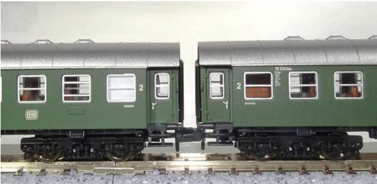
Bild 20: Kuppelabstand Umbauwagen ab Werk
