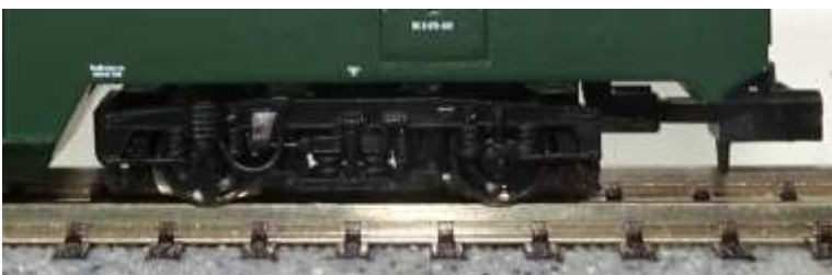
Bild 10: Drehgestell Görlitz VI mit Generator
