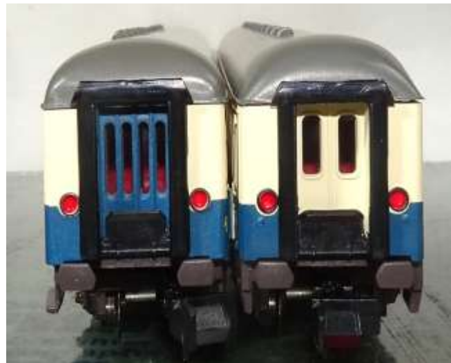
Bild 12: Übergänge Bm 232 und ABm 225
