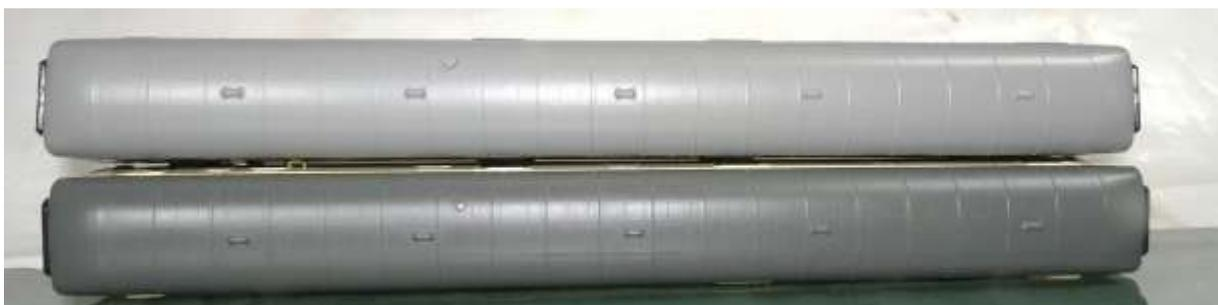
**Bild 7: Dach des Postwagens alt und neu (oben)**
