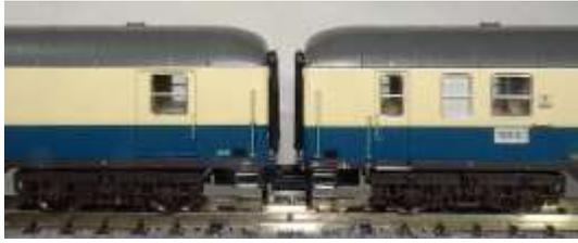
**Bild 10: Kuppelabstand mit Standardkupplung**
